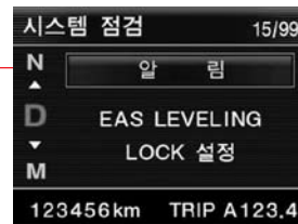
EAS 시스템 고정 (LOCK): 차량을 들어 올려도 에어누기 되지 않음
