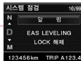
EAS 시스템 고정해제 (UNLOCK): 차량을 들어 올릴 경우 에어 누기
