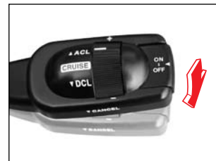
ACC 레버를 반대로 작동하면 ACC 시스템 작동이 중단됩니다.
